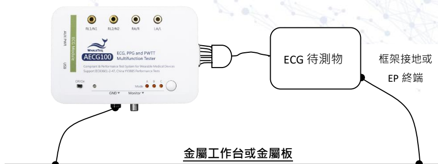
圖 8：降低雜訊 ECG 測試模式產品接線圖
