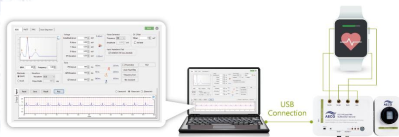
圖 7：ECG 測試模式產品接線圖
